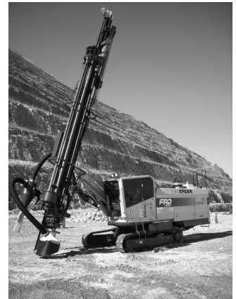
図2.12 ダウンザホールドリル
