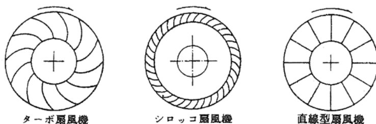
図 3.48 扇風機羽根の形状模式図
